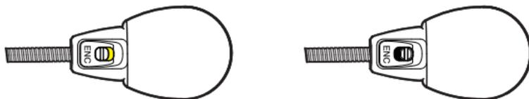
1. Cuando se coloca el interruptor en la posición ENC, se muestra el color amarillo y se activa la función ENC.
