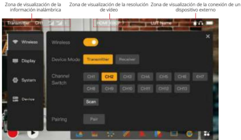
**Wireless:** Pulse en la zona de visualización de la información inalámbrica para acceder a la interfaz de la configuración inalámbrica cuando se muestre la barra de información superior.
