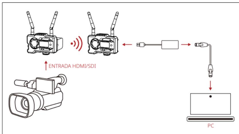
1. Compruebe que hay una visualización de formato de vídeo tanto en el transmisor como en el receptor. Utilice el conector de tipo C a LAN para conectar el portátil y el RX.
